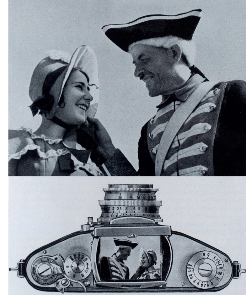
Door de spiegel staat het beeld in de lichtkapzoeker links-rechts verkeerd.
