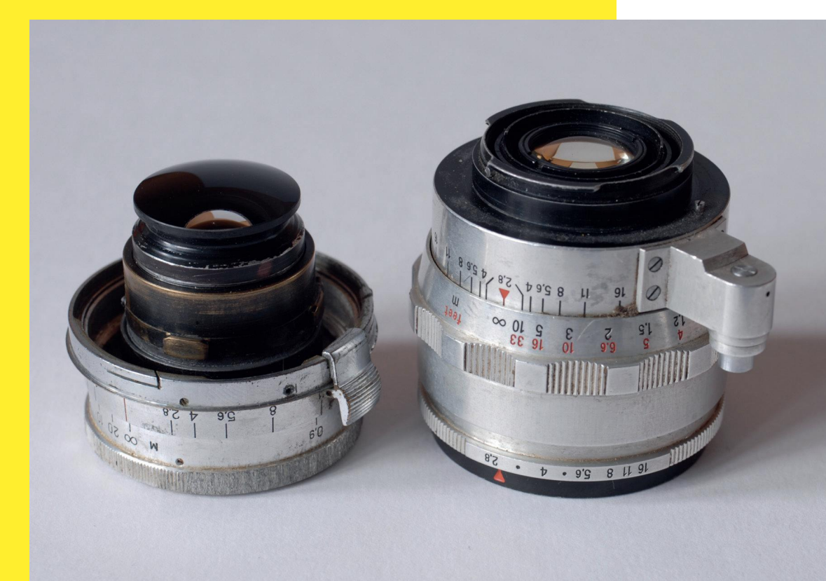
Twee groot-hoeklenzen voor kleinbeeldcamera's. De linker lens is bedoeld voor een meetzoekercamera en steekt diep de camera in. De rechter lens is voor een spiegelreflex camera (Exakta); deze lens valt maar een klein stukje naar binnen, omdat hij anders tegen de spiegel botst.
